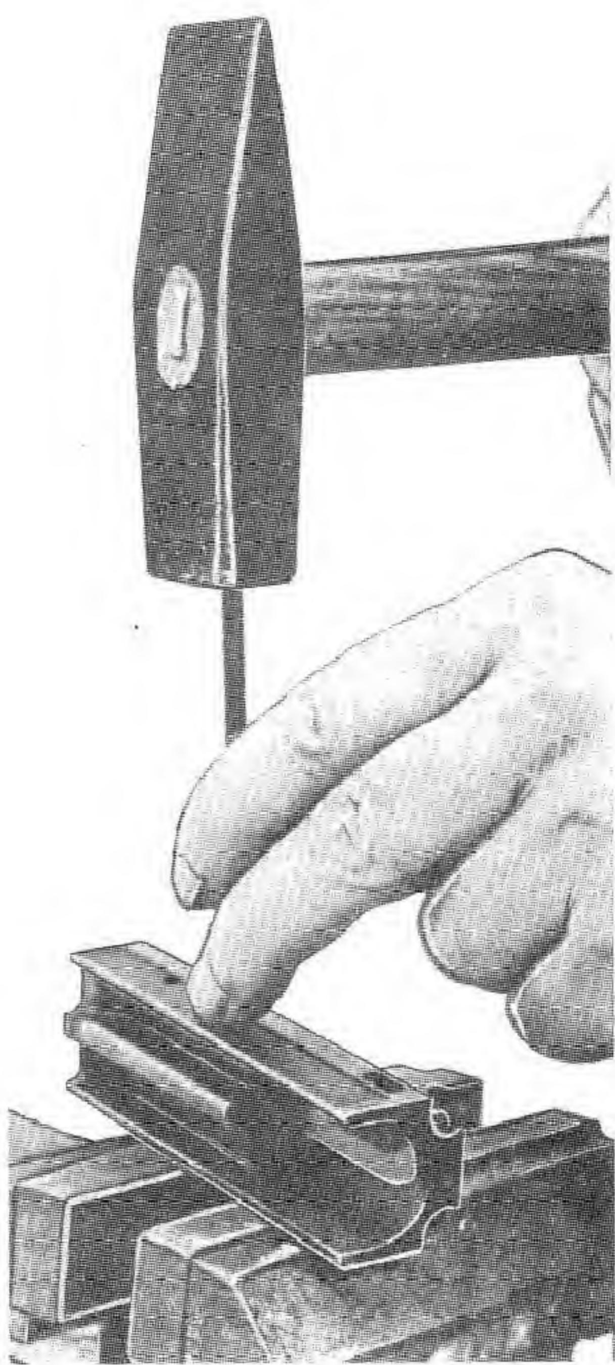
Sl. 67 – Odvajanje osovine izvlakača od zatvarača
